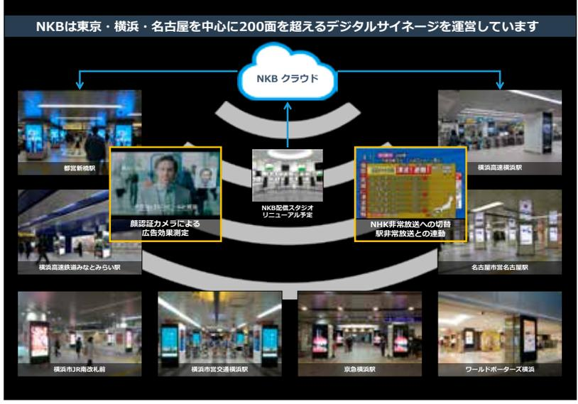
ジの運用につながっています。このクラウドの中に組み込まれたシステムは、単純に形式を変換しているだけでなく、動画、音声などのパラメタも同時に変換し正しいフォーマットとして出力するしくみになっています。このクラウドがあれば1つの素材で、各電鉄会社の形式に沿ったフォーマットに変換することが可能です。
